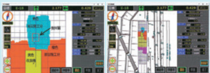
平面誘導時管理装置表示例(施工日ごとに着色)
