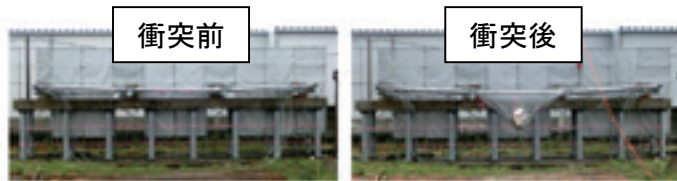
(例1) 落石エネルギー500kJ対応タイプ 実験事例
