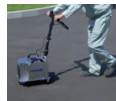
写真-2 多目的路面性状測定器
