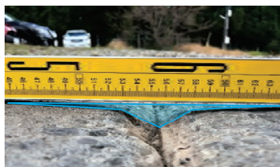
写真-2 目地部周辺の損耗量計測状況
