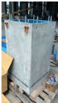
写真-5 漏水試験風景
