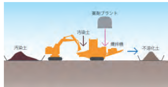
図-2 オンサイト不溶化処理 施工イメージ図
