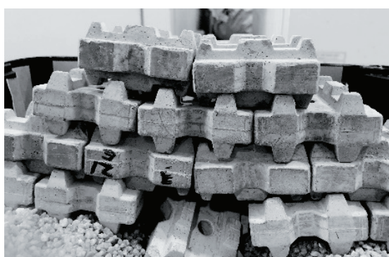
図-11 観察されたブロック積砂防堰堤における屈撓性能等の状況
