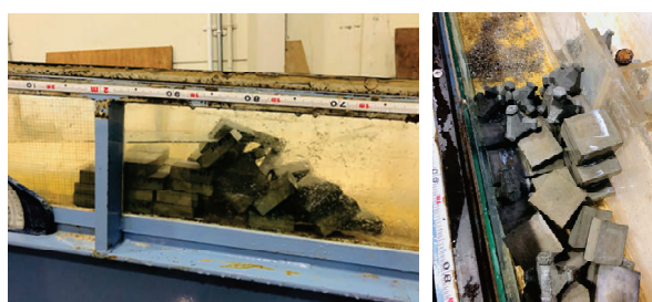
図-8 崩壊状況（左：ダム E，右：ダム J）
