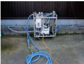
図-10 仮設水道に接続
