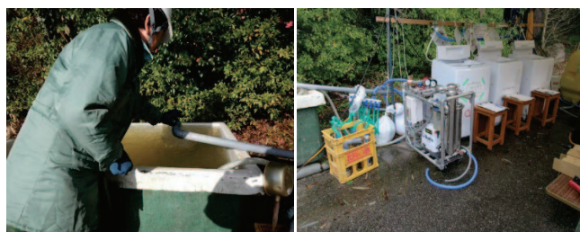
図-12 裏の沢の水(原水)と処理装置
