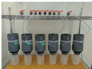
写真－5 ひび割れ透水試験状況
