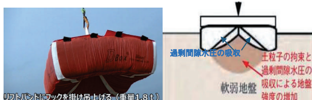
写真-4 D・Box 底部の円錐形状と下面の地盤状況
