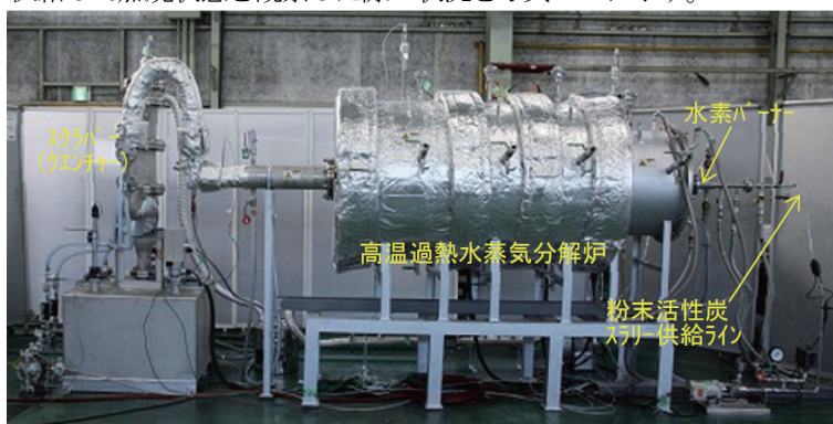
写真-3 水素燃焼式高温過熱水蒸気分解処理試験装置
