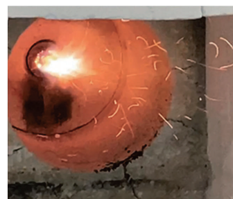
写真-4 粉末活性炭スラリー燃焼状況
