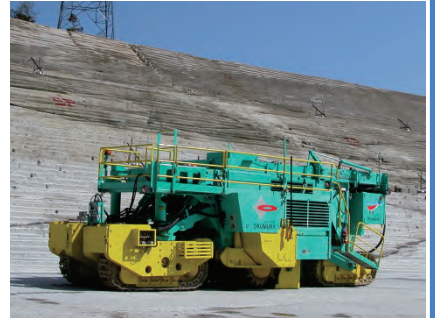
2500SM（掘削幅：2.5m）の全景
