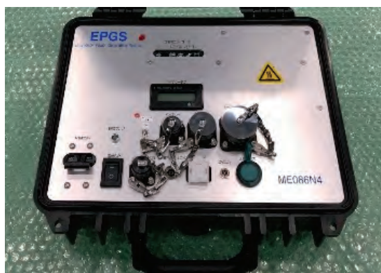
コントローラ+バッテリー
