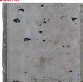
【プロコンシート(未使用)のコンクリート】 吸水率 3.1% (7日間浸せき)
