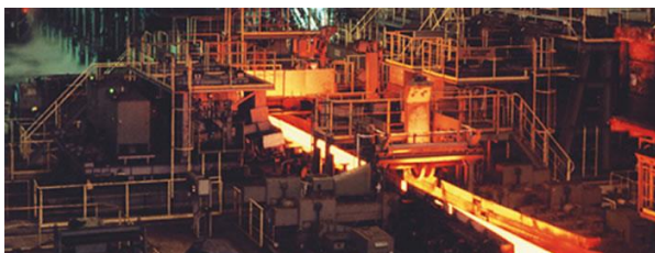
写真-3 熱間圧延工場内部 (八幡製鐵所ホームページから転載)
