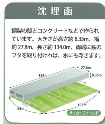
図-3 沈埋函トンネル部の概要
